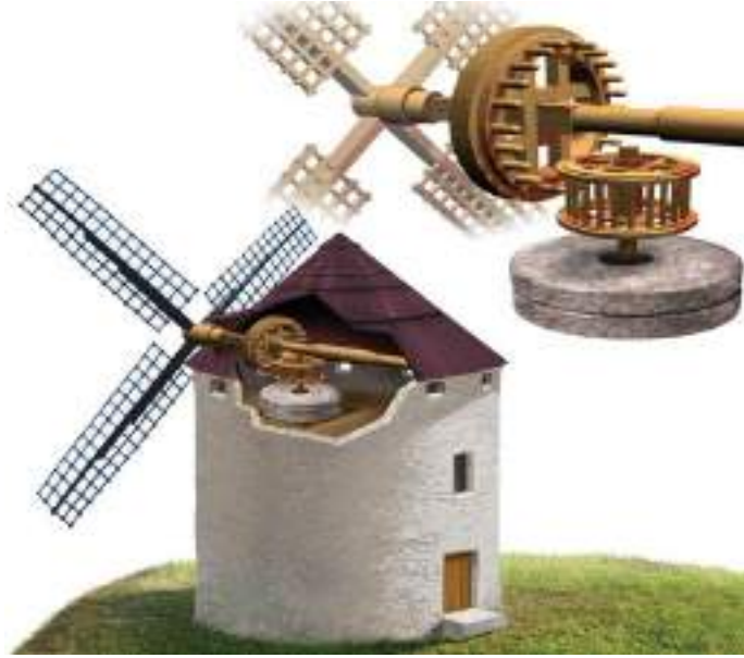
Figura 3 Salom C.(2016). Transmisión de la fuerza del viento a los engranajes de un molino. [Ilustración] Recuperado de http://www.salomart.com
